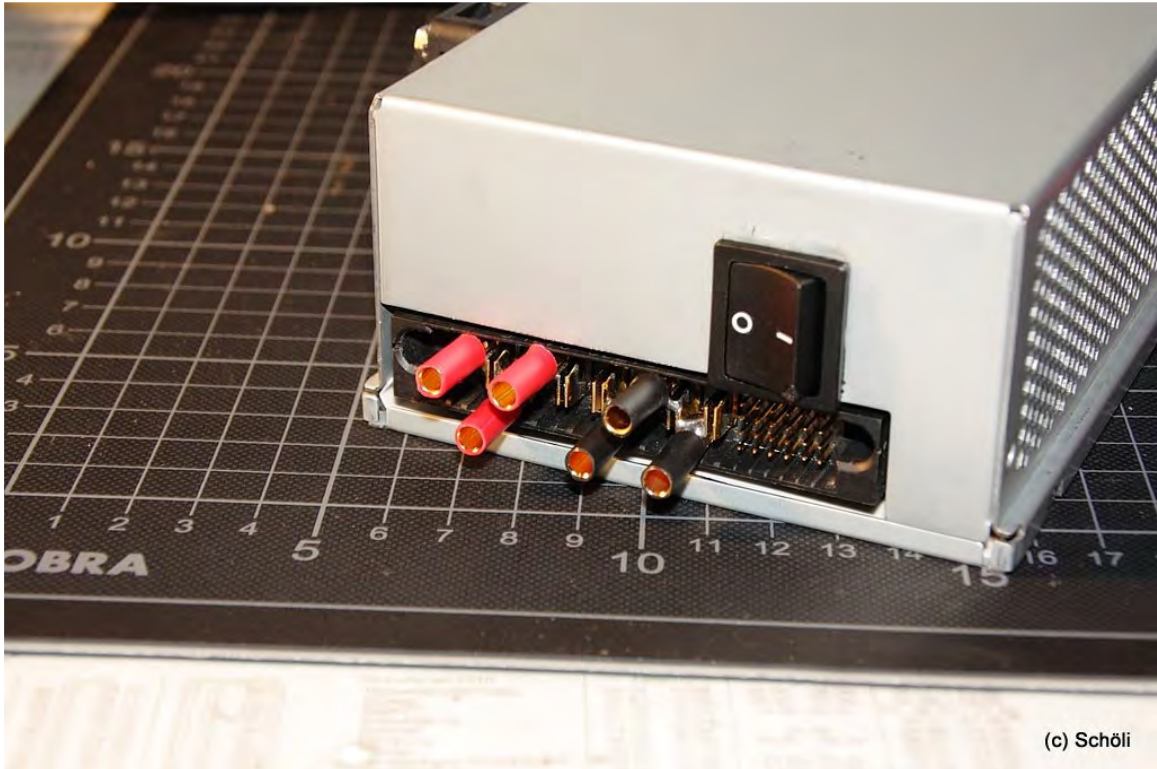
Bild 36: 4mm Buchsen verlötet und isoliert
